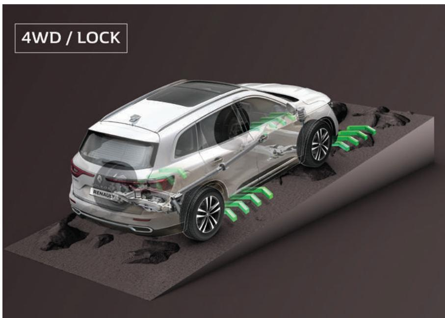
Seleccioná Auto para pasar automáticamente a modo 4WD cuando la situación lo requiera, y conseguí una distribución automática de torque entre las ruedas delanteras y traseras. Elegí el modo Lock para fijar el reparto de torque entre el tren delantero y trasero, manteniendo una transmisión permanente a las cuatro ruedas con el fin de maximizar la adherencia y la estabilidad en cualquier situación. Pasá a la acción con el All Mode 4WD del Renault Koleos.
