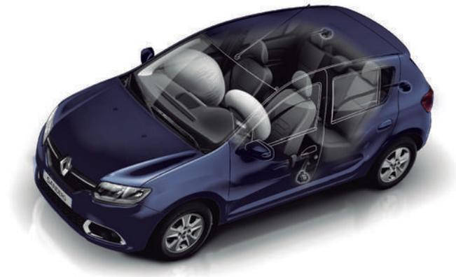
**Protección.** Airbags delanteros para conductor y acompañante. Cinturones de seguridad delanteros inerciales, ajustables en altura. Cinturones de seguridad traseros laterales inerciales y central ventral.
