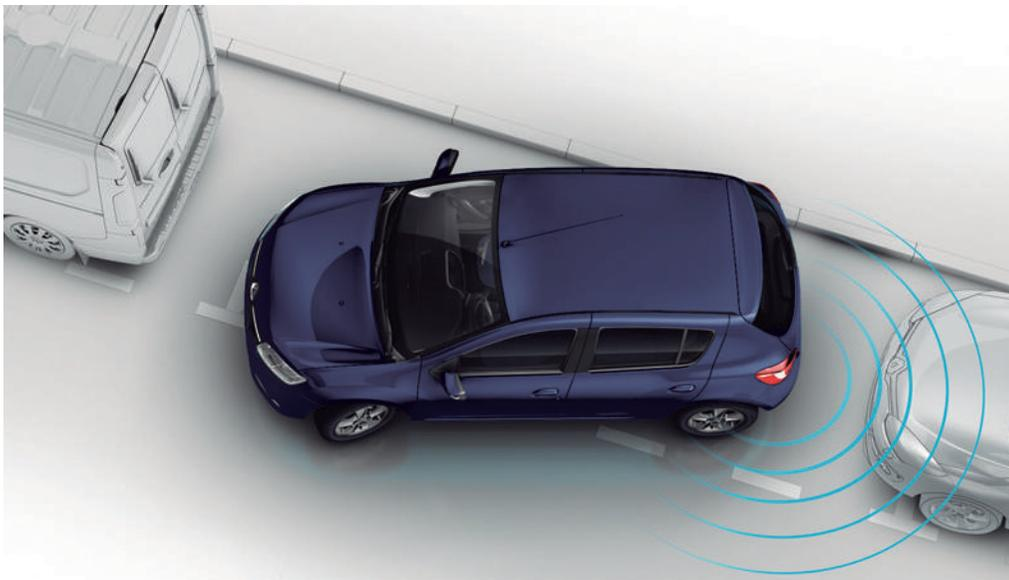
**Cuatro sensores de estacionamiento traseros.** Te ayudan en la maniobra de estacionamiento, advirtiéndote la presencia de cualquier elemento.
