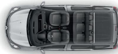
Caja semividriada / Transporte de pasajeros en la segunda fila de asientos / Funcionalidad 1/3 - 2/3 del respaldo trasero, volumen de carga hasta 3000 dm<sup>3</sup> / Asiento trasero rebatible, largo de carga hasta 1570 mm
